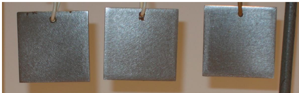
б) образцы покрытые тонким слоем ДТ с присадкой (2% ингибитора коррозии)
