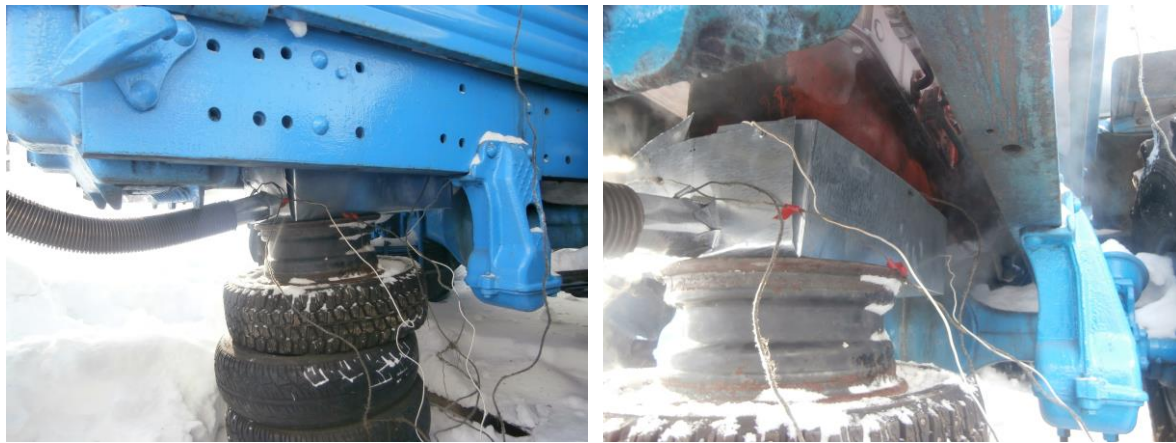
а - фальшподдон картера двигателя с рукавом;
