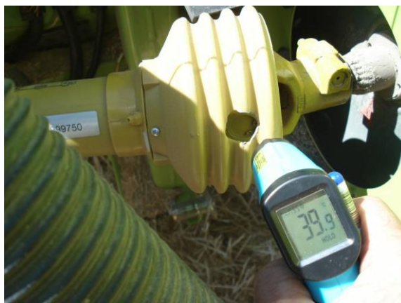
Рис. 6. Измерение диагностической температуры инфракрасным пирометром
