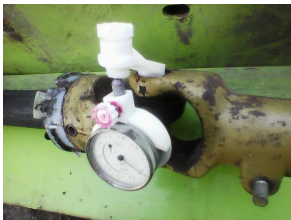
Рис. 7. Измерение суммарного окружного радиального зазора
