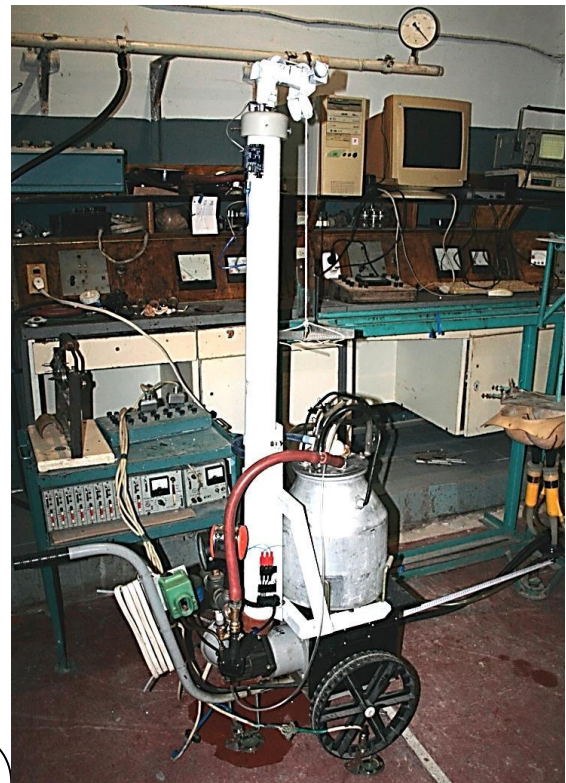
Рис. 5. Стенд для определения положения центра тяжести мобильного агрегата
