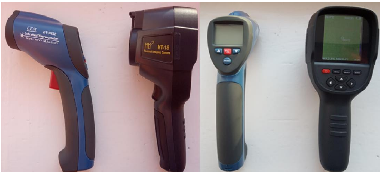
а) пирометр (вид с боку) б) инфракрасный тепловизор (вид с боку) в) пирометр (вид сверху) г) инфракрасный тепловизор (вид сверху)
