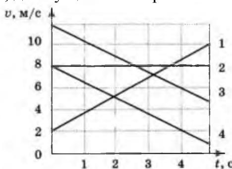
Для какого (-их) из тел – 1, 2, 3 или 4 – вектор ускорения направлен противоположно вектору скорости?
