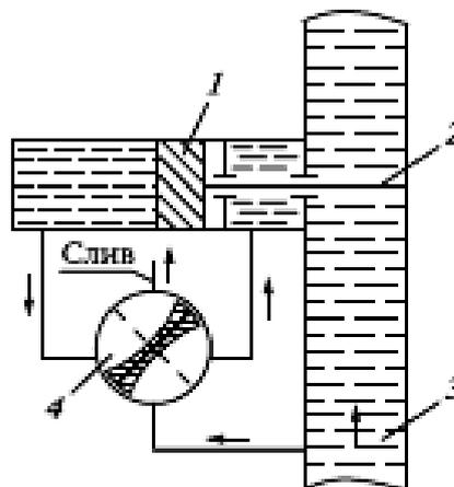
1 – поршень силового цилиндра; 2 – заслонка; 3 – трубопровод;
