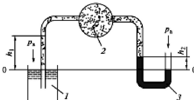
1 – бак с водой; 2 – баллон с воздухом, давление которого  $p$ ; 3 – ртуть
