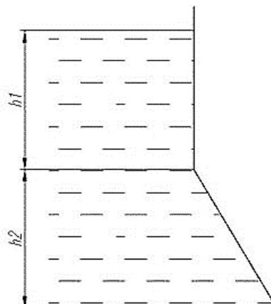
Рисунок 9.1 – Вертикальное сечение плоских стенок резервуара
