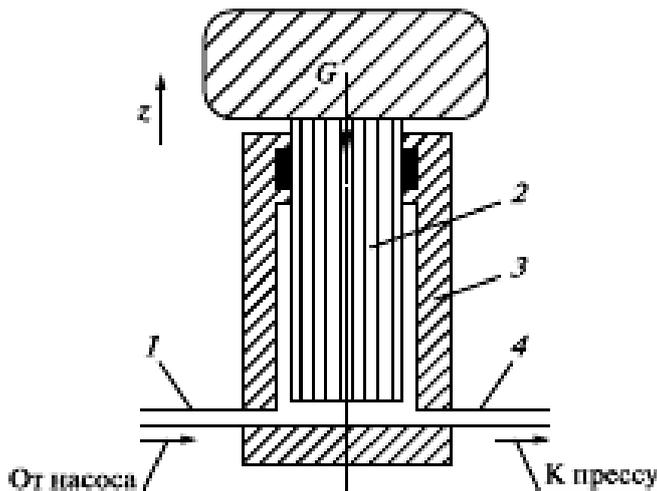
1 – трубка для подачи воды от насоса; 2 – плунжер;
