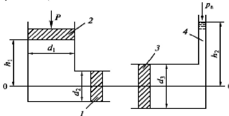
1, 2, 3 – поршни; 4 – пьезометр
