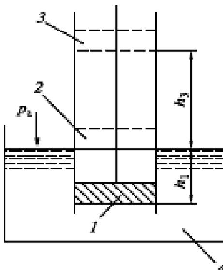
1, 2, 3 – три положения поршня; 4 – резервуар с водой
