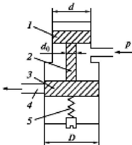
1, 3 – поршни; 2 – шток; 4 – отверстие для отвода жидкости; 5 – пружина
