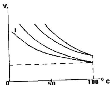
4. На графике с вязкостно-температурными кривыми четырех масел масло с высоким индексом вязкости соответствует кривой... (I, II, III, IV).
