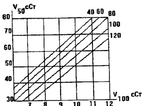
3. Если кинематическая вязкость масла при 100 °C равна 10 мм<sup>2</sup>/с, а при 50 °C – 50 мм<sup>2</sup>/с, то в соответствии с номограммой индекса вязкости масла равен ... (60, 80, 100, 120).
