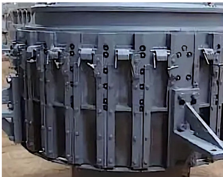
Рис. 4 – Центробежная машина для нарезания сахарной свеклы Т2М-СЦ2Б-16
