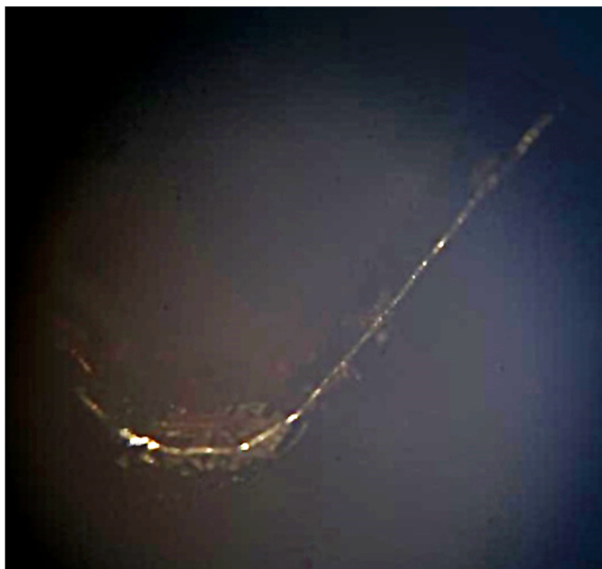
Рис. 3 – Округление режущей кромки ножа центробежной свеклорезки (увеличение \times 100 )
