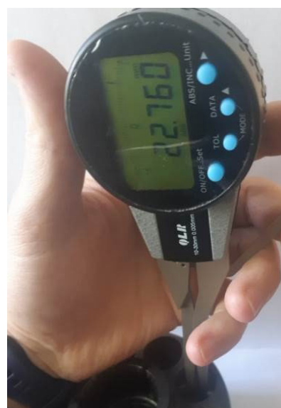
б) отверстие корпуса
