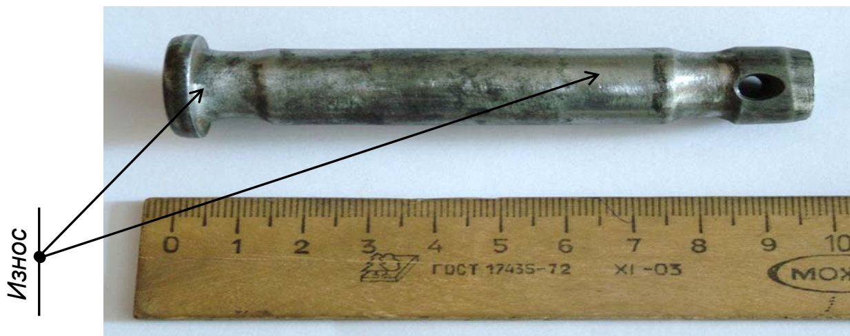
Рис. 1. Изношенный палец 219468 пневматической сеялки John Deere 730
