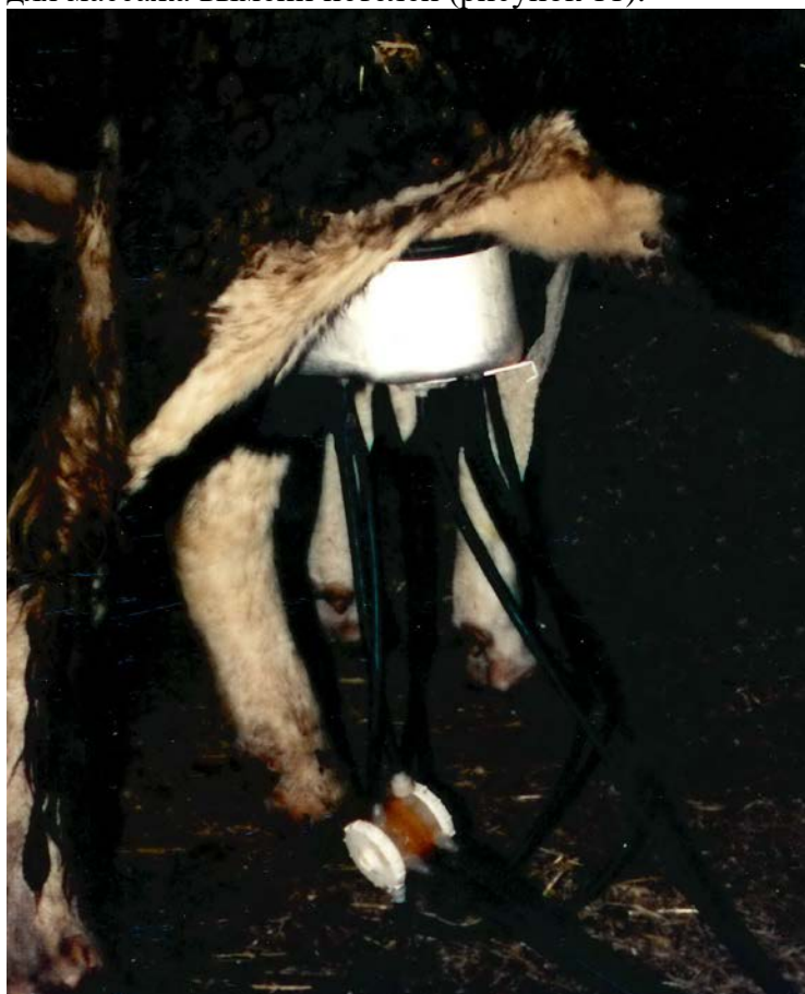
Рис. 11. Опытный образец устройства для массажа вымени нетелей
