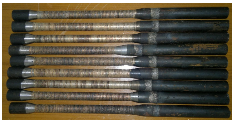
Рис. 1 – Общий вид упрочненных цилиндрических образцов
