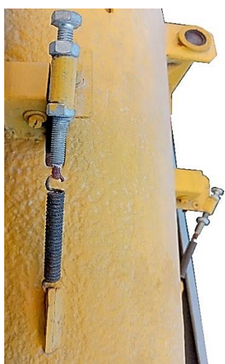
а) – механизм предварительного натяжения пружин в зоне начального этапа обмолота
