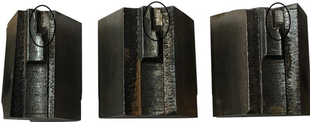
Рис. 1 – Износ боковых поверхностей на фрагментах муфты фланца ВОМ 150.41.275-1
