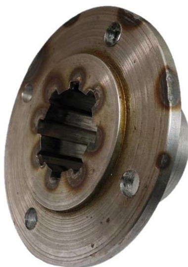
Рис. 6 – Муфта фланца привода ВОР 150.41.275-1 с характерно выраженными зонами термического воздействия
