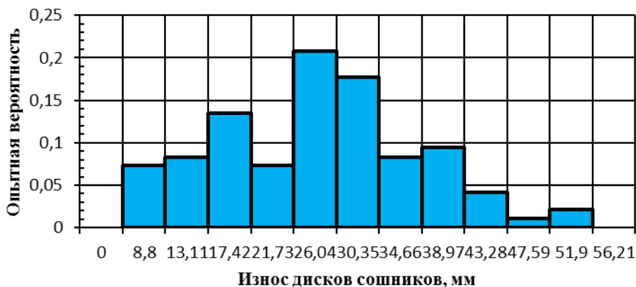
Рис. 4 - Гистограмма опытных вероятностей распределения износа дисков
