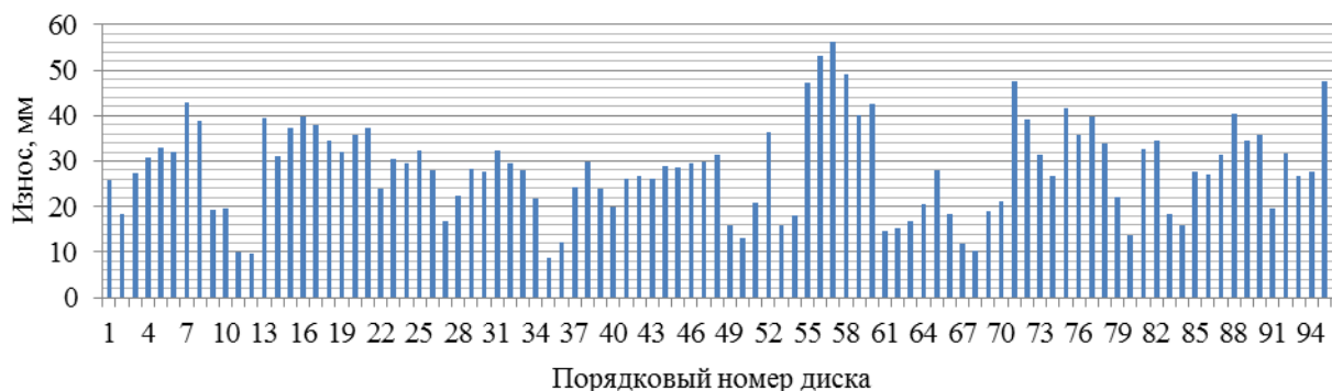
Рис. 3 - Общее графическое представление износа дисков сошников сеялок
