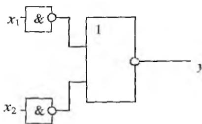
а)  $y = x_1 - x_2$       б)  $y = x_1 \vee x_2$       в)  $y = \overline{x_1 x_2}$       г)  $y = \overline{x_1 \vee x_2}$
