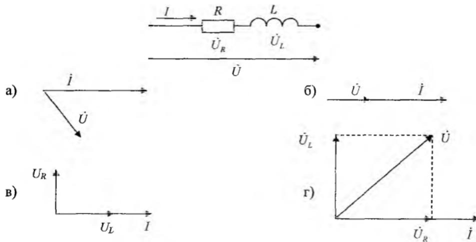
22. Условие возникновения резонанса в последовательном контуре имеет вид:
