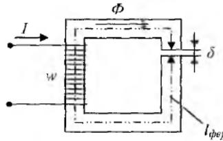
а)  $l_w = B_{\phi ep} l_{\phi ep} + B_{\delta} \delta$    б)  $l_w = H_{\phi ep} l_{\phi ep} + H_{\delta} \delta$    в)  $l_w = B_{\phi ep} / l_{\phi ep} + B_{\delta} / \delta$    г)  $l_w = B_{\phi ep} l_{\phi ep} + B_{\delta} \delta$
