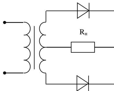
а) двухполупериодного с выводом средней точки обмотки трансформатора
