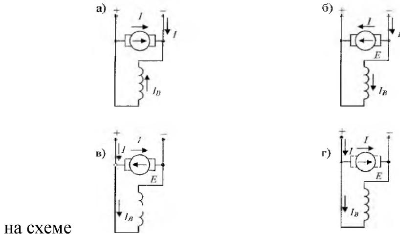
9. Если естественная механическая характеристика двигателя постоянного тока параллельного возбуждения - прямая А, то группе искусственных характеристик Б соответствует способ регулирования частоты вращения ротора изменением:
