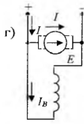
9. Если естественная механическая характеристика двигателя постоянного тока параллельного возбуждения - прямая А, то группе искусственных характеристик Б соответствует способ регулирования частоты вращения ротора изменением:
