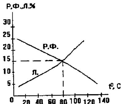
2. Используя график зависимости количества рабочей фракции и лака, полученный в результате испытаний на аппарате папок, определите термоокислительную стабильность... (15%, 80 мин, 120 мин, 25%)
